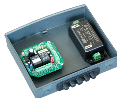
Gehäuse SUN, Decoder inkl. Netzteil eingebaut. (optional)
